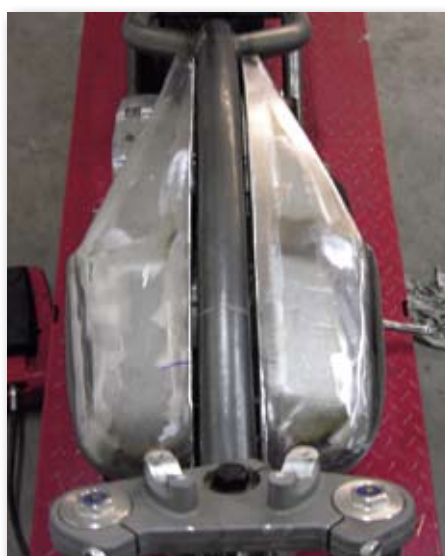
Passt! Beide Hälften fügen sich saugend ans Rahmenrohr
