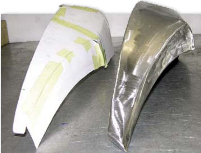
Zum Vergleich: Die Papier-Vorlage und das Werkstück aus Metall
