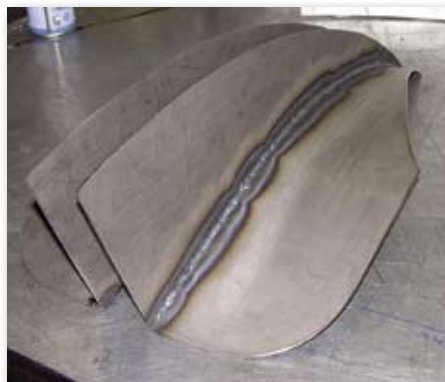
Die Segmente werden aus Metall nachgeschnitten und verschweißt
