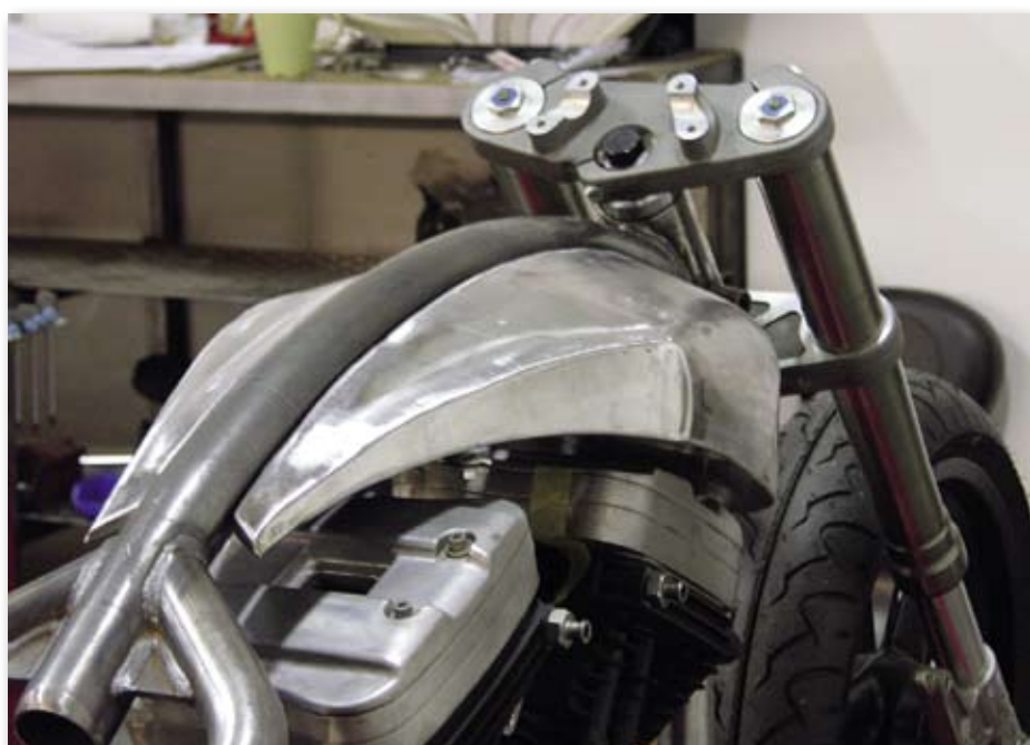
Passt! Beide Hälften fügen sich saugend ans Rahmenrohr
