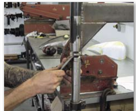
Grobe Arbeiten erleichtert die selbstgefertigte Dengelmaschine
