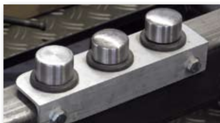
Verschiedene Formteile in der Dengelmaschine ermöglichen verschiedene Wölbungsgrade
