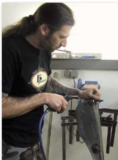
Nicht vergessen: Tank trocknen! Der unbearbeitete Rohling ist rostanfällig
