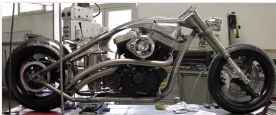
Fertig! So schön kann ein Buell-Motor verbaut werden. Er wurde allerdings auf Vergaserbetrieb umgerüstet. Einspritzanlagen erfordern eine Menge Innereien an Pumpen und Filtersystemen, die sich in einem Custom-Tank nicht so einfach unterbringen lassen
