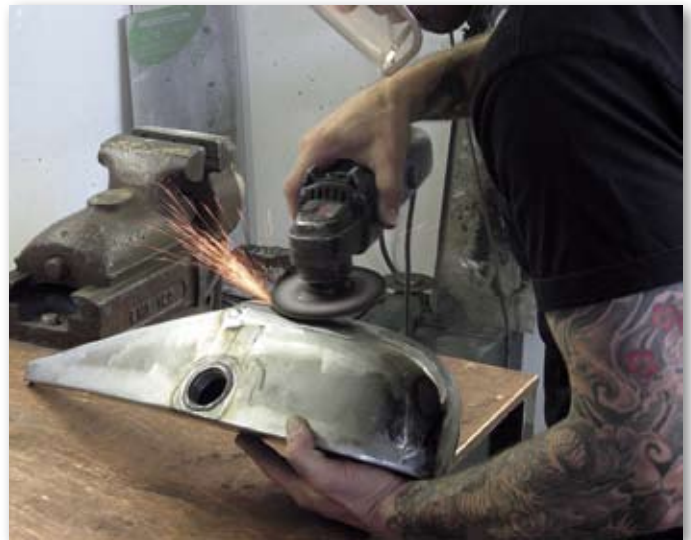
Die Flex entfernt grobe Unebenheiten vom Tankrohling
