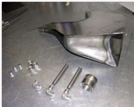
Ausgefallene Formen bevorzugt. Hier der Öltank des gleichen Projekts. Sogar die Anschlusssteile sind in diesem Fall Eigenbauten
