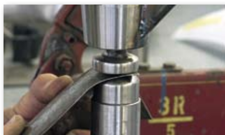
Verschiedene Formteile in der Dengelmaschine ermöglichen verschiedene Wölbungsgrade
