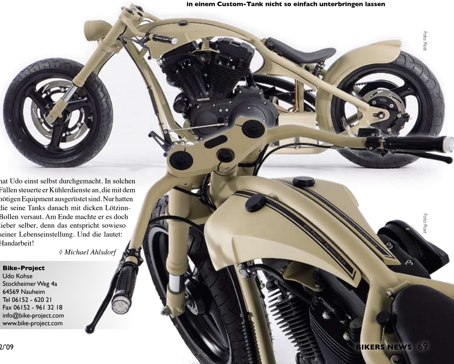
Fertig! So schön kann ein Buell-Motor verbaut werden. Er wurde allerdings auf Vergaserbetrieb umgerüstet. Einspritzanlagen erfordern eine Menge Innereien an Pumpen und Filtersystemen, die sich in einem Custom-Tank nicht so einfach unterbringen lassen
