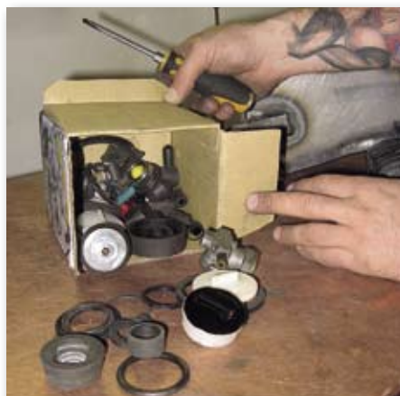
Für die Druckprüfung liegen die verschiedensten Verschluss- und Adapterstücke bereit ...
