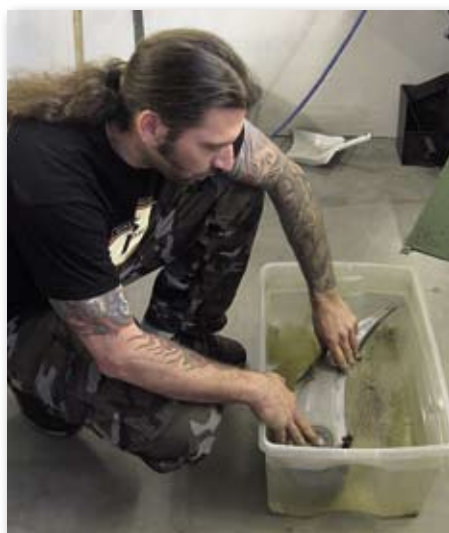
Das Wannenbad offenbart gnadenlos die kleinsten Undichtigkeiten
